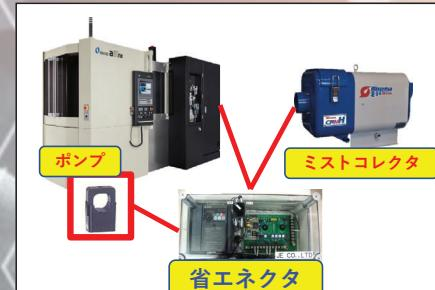
汎用加工機は、クーラントポンプ等にセンサを取り付け、ミストコレクタを連動
