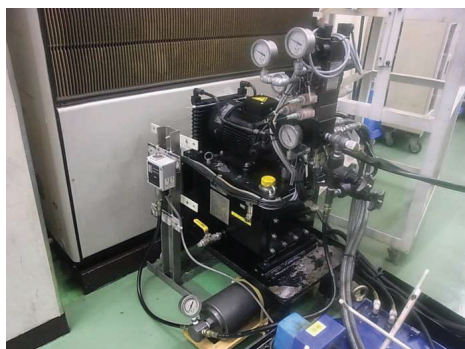
可変ベーンポンプ式油圧ユニット 電動機1.5kW4P タンク容量20L
