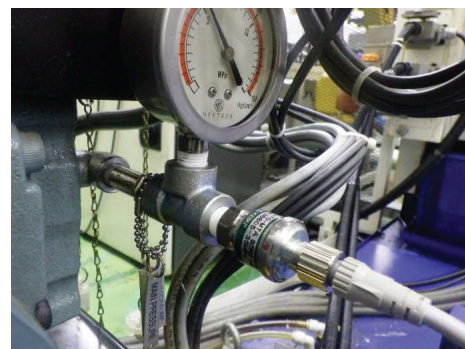
圧力センサ (圧力を電圧に変換してインバータへ入力)
